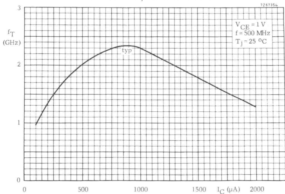
Fig. 3 V_{CE} = 1\text{ V} ; f = 500\text{ MHz} ; T_j = 25\text{ }^\circ\text{C} ; typical values.
