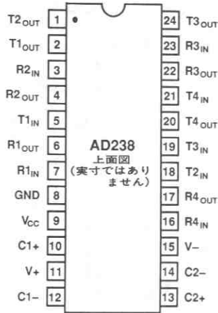
図17. AD238 DIP/ SOICピン配置
