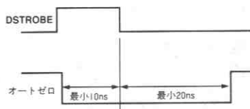
図17. オートゼロ入力のセットアップおよびホールド時間
