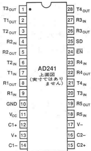
図21. AD241 SOICピン配置
