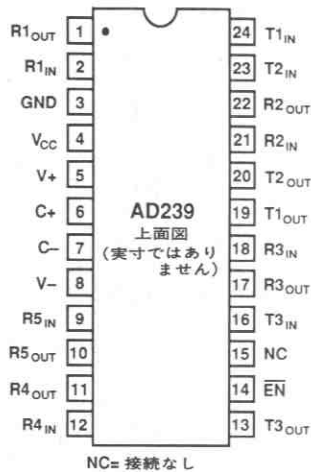
図19. AD239 DIP/ SOICピン配置
