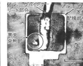
図13. 図12の試料をアルミニウム除去したものを (金属顕微鏡による解析)
