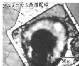
図8. アルミニウム蒸着配線腐食例 (金属顕微鏡による解析)
