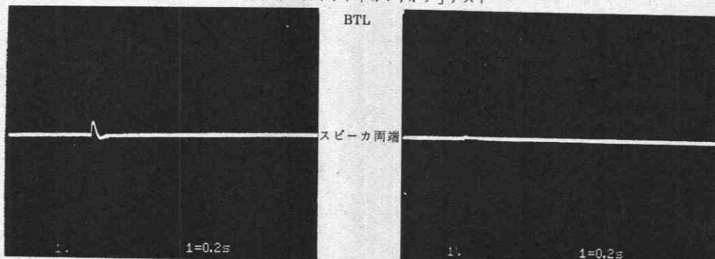
BTL スピーカ両端 V_{CC}=13.2V スタンバイ+5V R_L=4\Omega R_g=0 スタンバイスイッチ「オン/オフ」テスト
